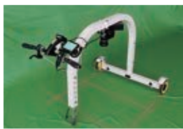
(株)イクシス 床面ひび割れ検知ロボット(手動式) 「Floor Doctor」
