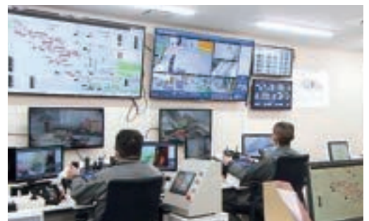
平成31年～ 特定廃棄物セメント固型化処理施設に4台導入し、無線遠隔操縦で稼働中
