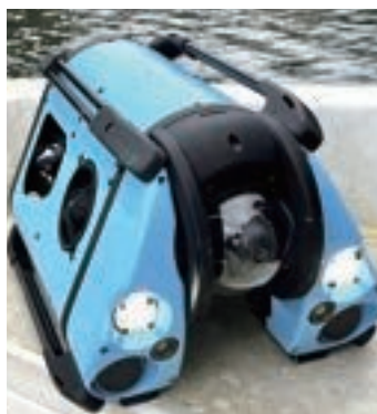
株キューアイ ダムや海洋等の水中調査を行う 「水中ドローン型ダム調査ロボットシステム」
